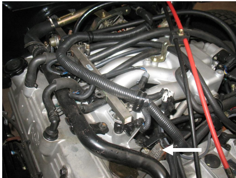
Рис.1.6.3. Идентификационный номер двигателя
