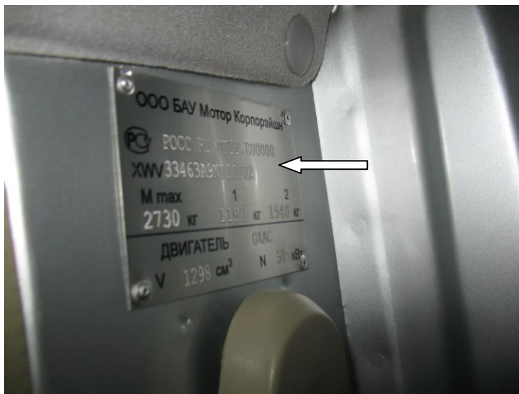
Рис. 1.6.1. Расположение заводской таблички на стойке кабины
