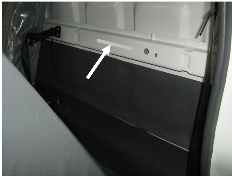
Рис.1.6.4 Идентификационный номер кабины
