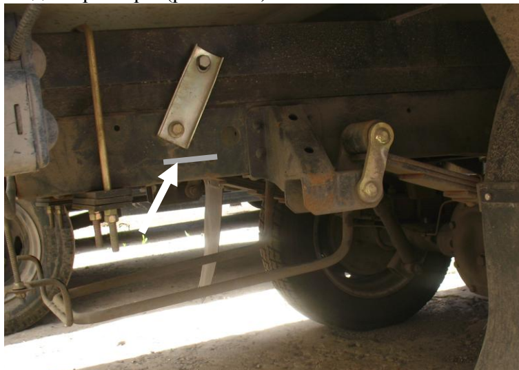
Рис. 1.6.5 Идентификационный номер шасси
