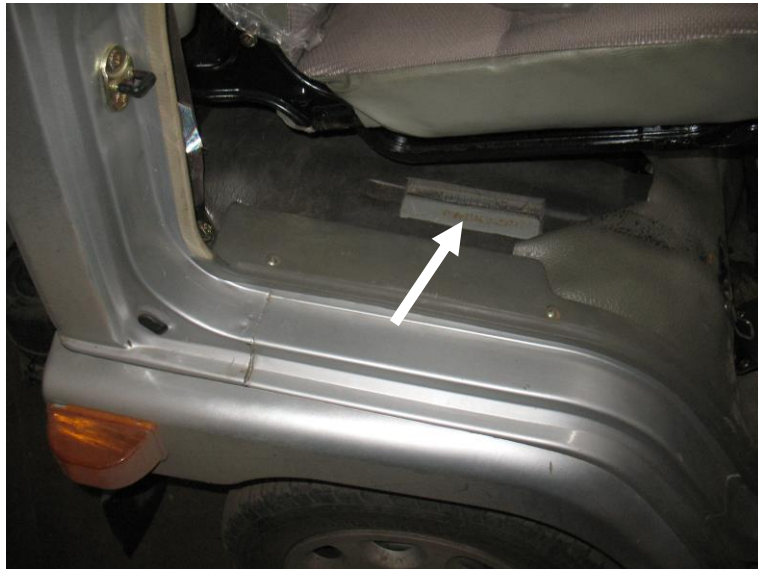
Рис.1.6.2 Расположение идентификационного номера автомобиля на панели кабине
