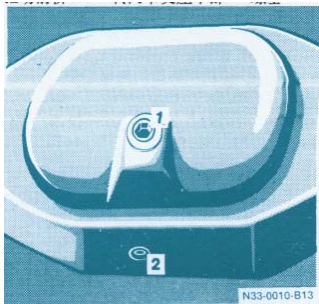
Приводной передний мост AL7 1. заливная пробка 2. сливная пробка
