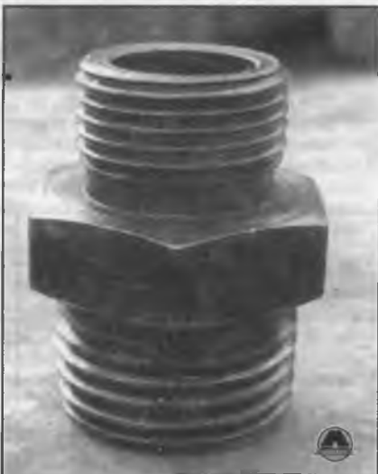
Фото 2. Присоединительная резьба (M20x1.5) штуцера в корпус крышки масляного фильтра.
