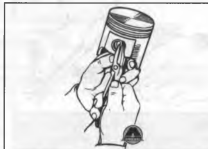
Рис. 10.6.1. Снятие (установка) стопорного кольца поршневого пальца.
