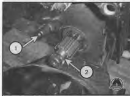
Рис. 10. 1. Место крепления опорного рычага, 2. Вал разжимного кулака.
