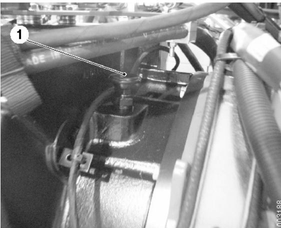
1. Filtro de respiración, en parte superior del convertidor de par.
