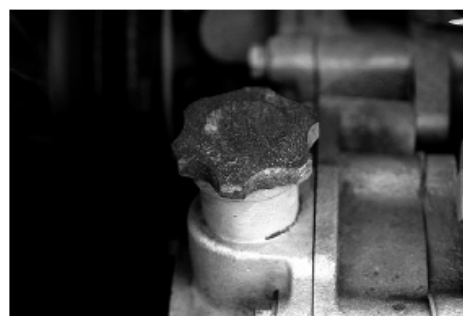
Fig. 5-12 Posición de boca de llenado de aceite en motor
