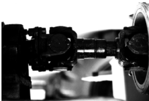
Fig. 5-4 Posición de lubricación de eje de transmisión trasero
