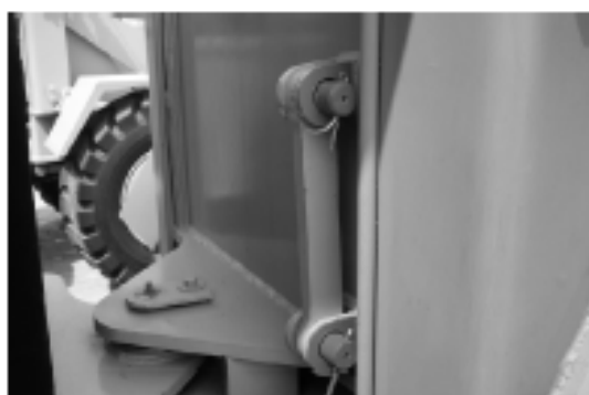
Fig. 3-4 Varilla de bloqueo
