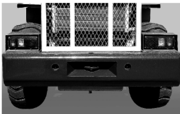
Fig. 3-5 Pasador de remolque en trasero
