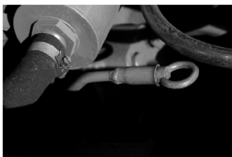
Fig. 5-11 Posición de regla de aceite de motor
