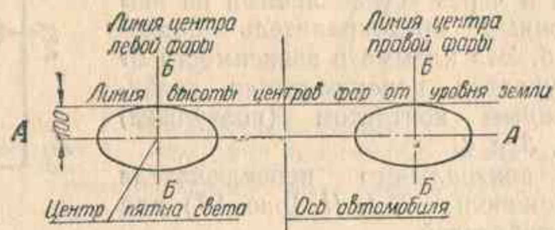
Рис. 98. Разметка экрана для регулировки света фар
